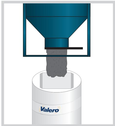
Pour les coffrages avec joint de dilatation : le coulage du béton doit se faire de manière simultanée dans les deux parties du coffrage afin d'éviter un excès de pression dans un des compartiments.
