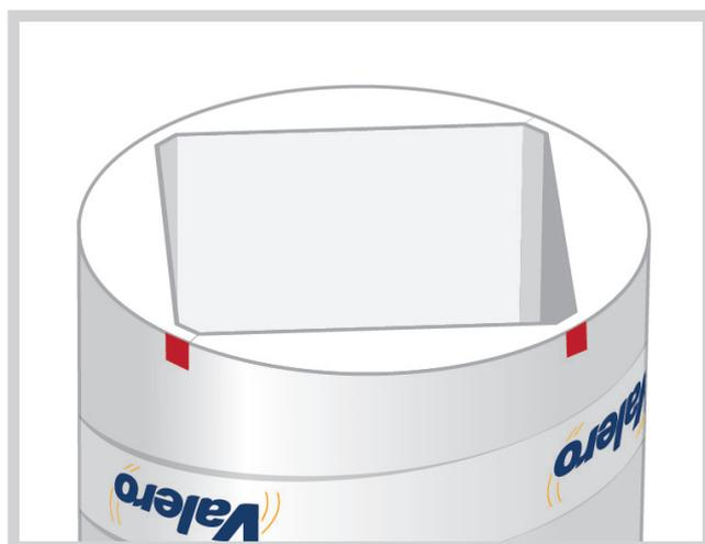
Avant de positionner le coffrage, réaliser un marquage au sol des dimensions du poteau. Puis, marquer sur la paroi extérieure du coffrage les points correspondants aux projections du poteau et les faire coïncider avec les marquages précédemment dessinés au sol.
