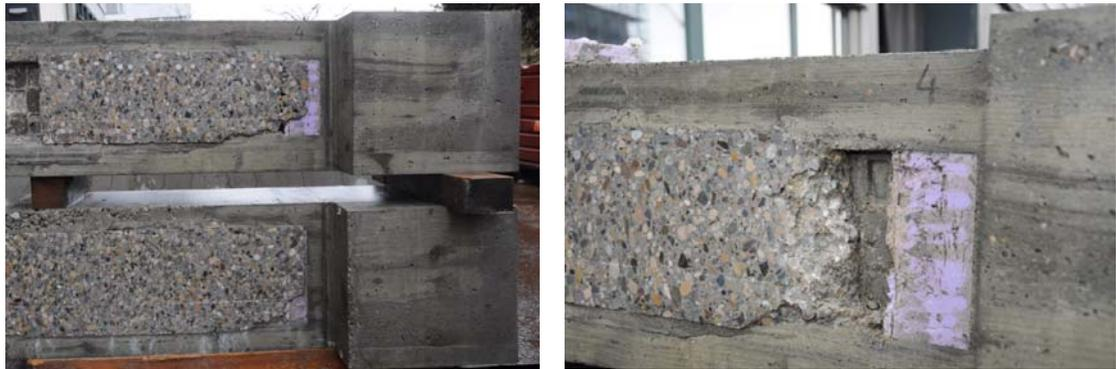
(a) Vue d'une face du joint coupé du spécimen 7 (en haut) et du spécimen 8 (en bas, correctement bétonné)
