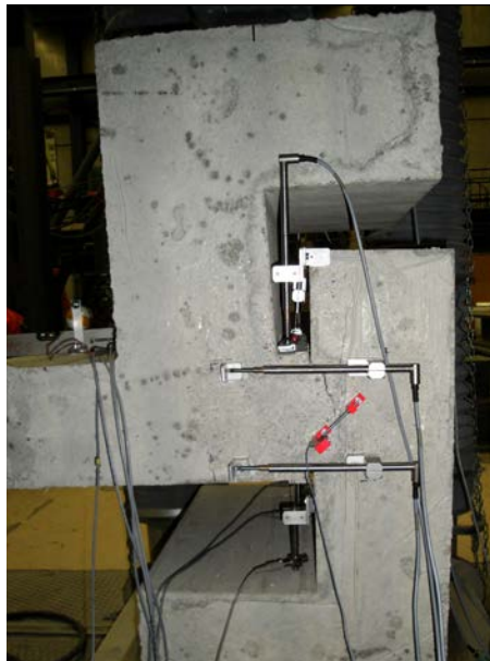
Figure 4.4: Mode de rupture du Spécimen 1
