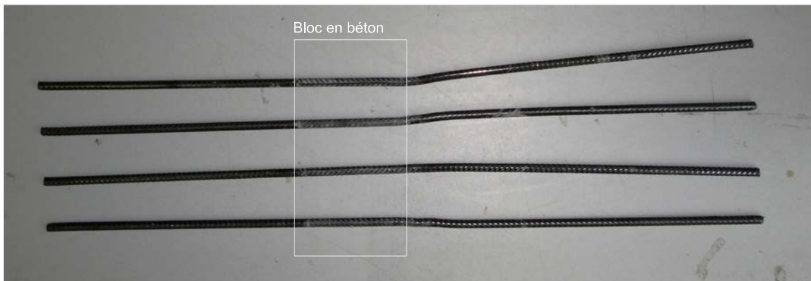
(b) Barres \phi 12 après rupture
