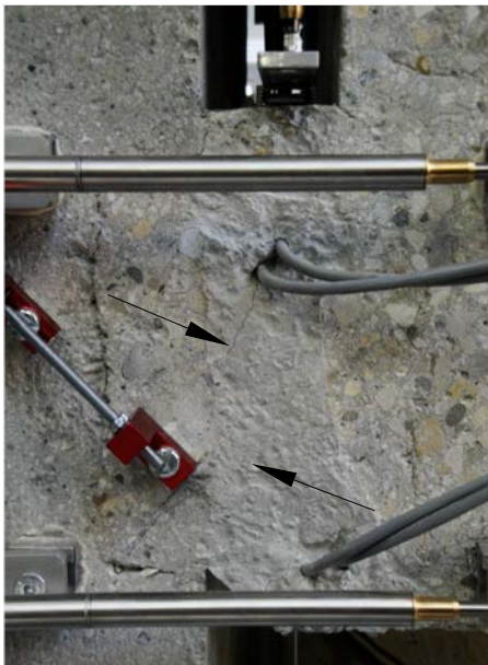
Figure 4.6: Mode de rupture du Spécimen 4
