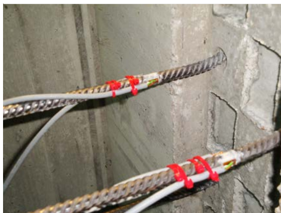
Figure 2.2: Partie “mur” décoffrée avec armatures en attente dépliées et le relief de l’interface du joint.
