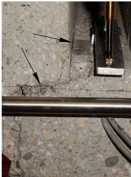
(d) Rupture, fissure de compression, à 535 kN
