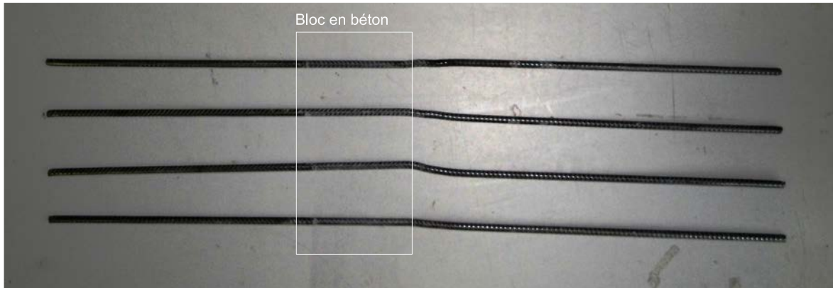
(b) Barres \phi 10 après rupture
